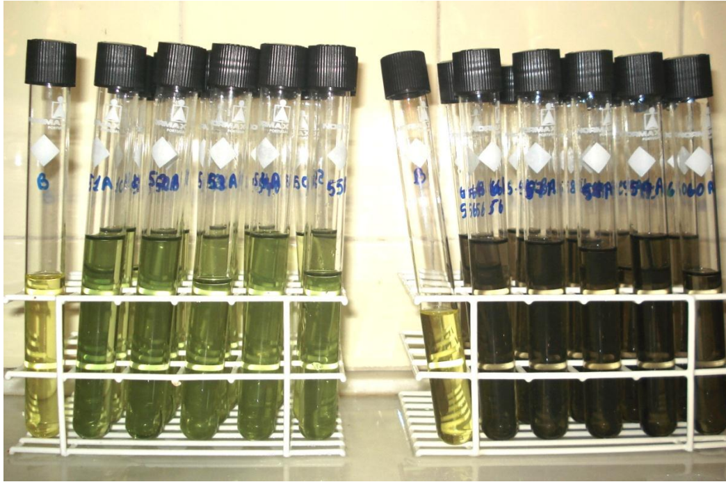
Figura 13- Etapa de quantificação do teor de 3,6 anidrogactose no ágar de Gelidiella acerosa , as amostras com coloração mais clara e mais escura representam baixos e altos teores de 3,6 anidrogactose respectivamente.
