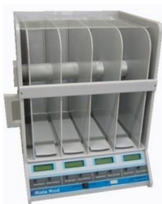
Figura 7 – Aparelho Rota Rod (modelo EFF 411 - INSIGHT®)
