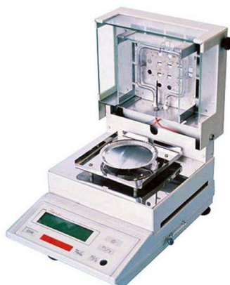
Figura 6 – Determinador de umidade (Série ID Versão 1.8 - Marte®)
