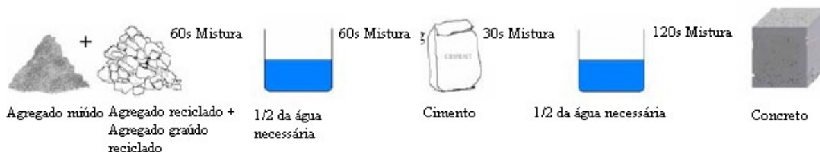
Figura 3 Método de mistura TSMA (Fonte: Tam, Gao; Tam, 2005)
