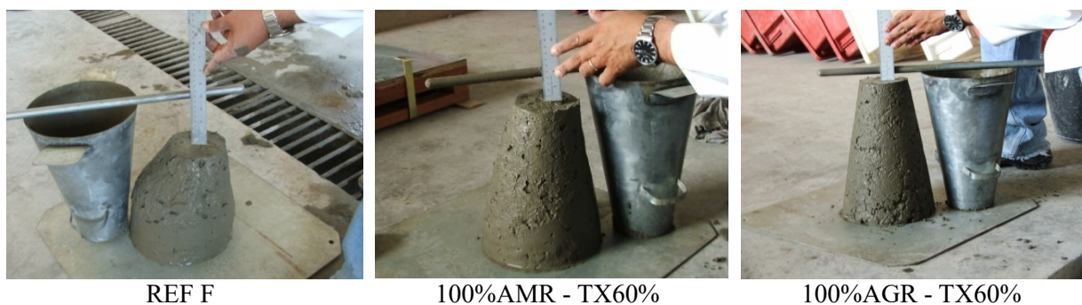
Figura 20 Comparação entre os abatimentos dos concretos de referência, 100%AMR e 100% AGR, com 60% de taxa de compensação para ambos
