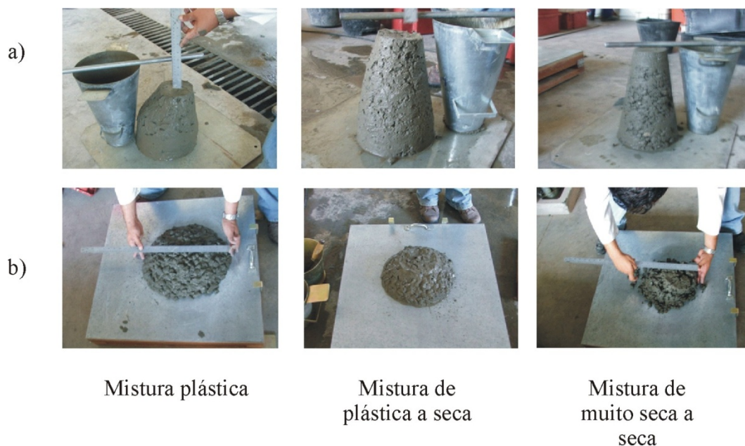
Figura 27 Comparação entre o ensaio de abatimento e espalhamento para visualização das classes de consistência: a) Abatimentos de misturas com diferentes consistências; b) Espalhamento de misturas com diferentes consistências
