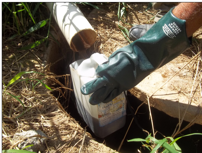
Figura 3.12: Coleta do lixiviado no Aterro Sanitário de Cruz das Almas/BA
