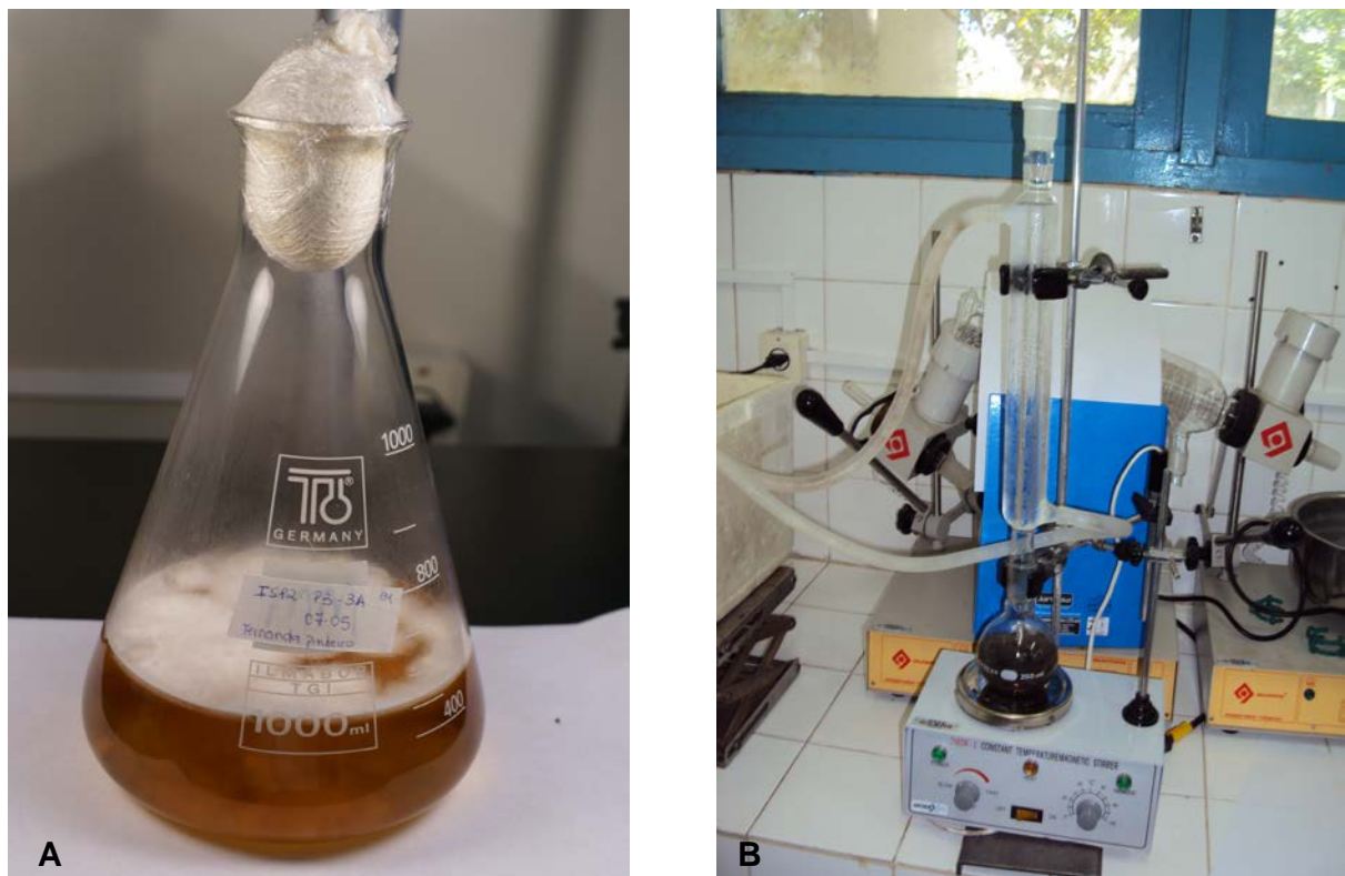
Figura 12. Obtenção dos extratos dos fungos endofíticos isolados. A- Crescimento de um dos fungos isolados neste trabalho em frascos Erlenmeyer; B- Equipamento de extração por refluxo do micélio do fungo.
