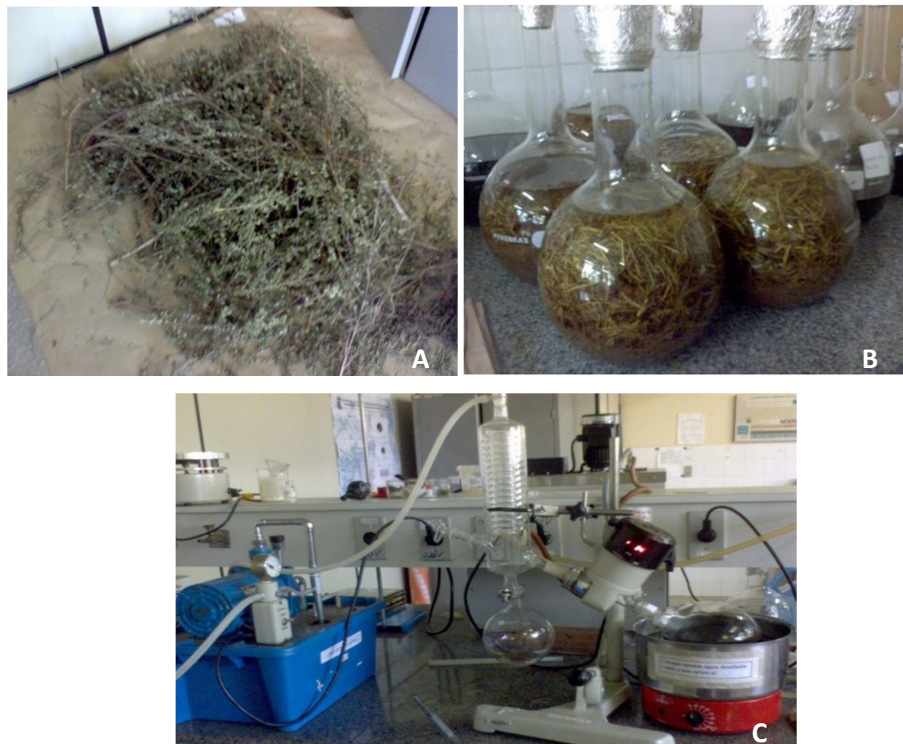
Figura 1: Secagem à temperatura ambiente do material botânico coletado (A); maceração em metanol dos órgãos das espécies vegetais (B); concentração do extrato metanólico em rotaevaporador (C).
