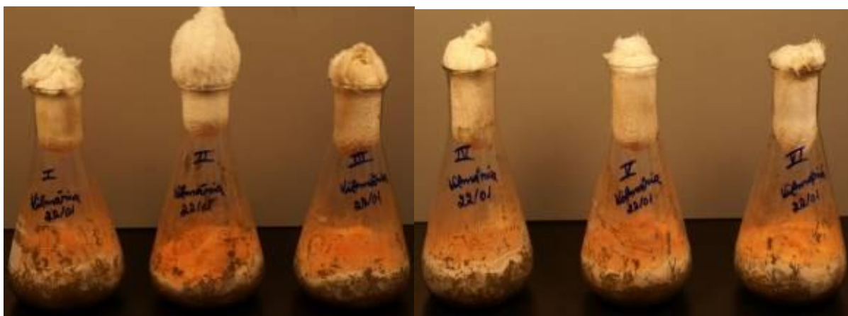
FIGURA 13 - Terceiro ensaio: Frascos Erlenmeyers contendo meio (solo + bagaço de cana + água) inoculados com o fungo Foto: A autora (2009)
