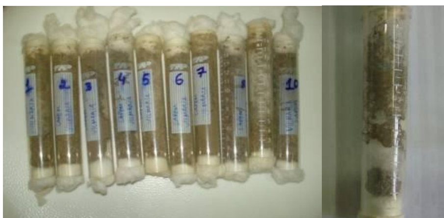
FIGURA 6 - Primeiro ensaio: Tubos Falcon contendo meio (solo + bagaço de cana + água) inoculados com o fungo. Foto: A autora (2009)
