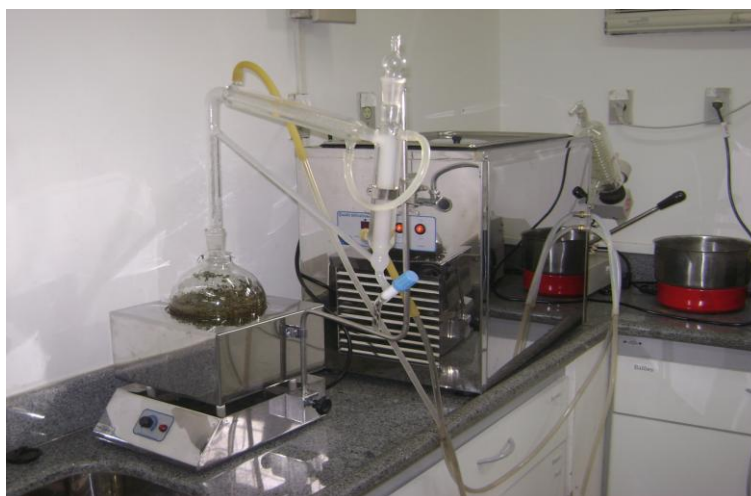
Figura 08. Hidrodestilação de óleo essencial de Ageratum conyzoides L. Sistema Clevenger acoplado ao condensador e banho-maria ultra-termoestático. Feira de Santana-BA, julho de 2010.
