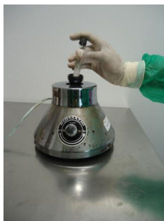
Figura 17 - Homogeneização da amostra no Vortex
