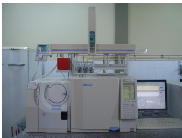
Figura 07 - Cromatógrafo a gás Shimadzu CG-2010
