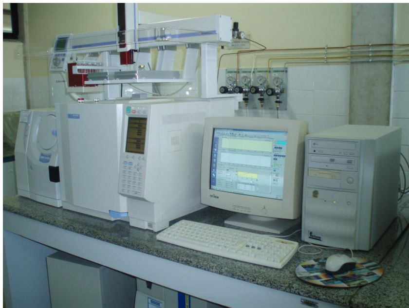
Figura 12 – Cromatógrafo a Gás acoplado a Espectrômetro de Massa (CGMS)
