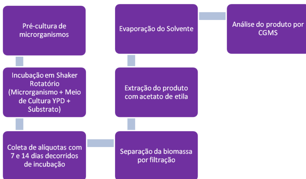
Figura 10 – Fluxograma do Processo de Biotransformação
