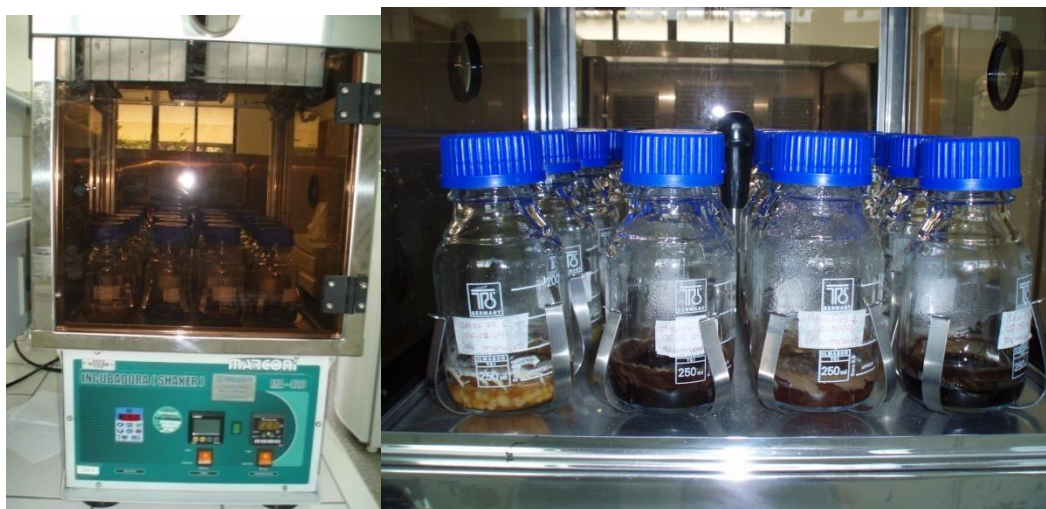
Figura 11- Câmara Incubadora com Agitação Orbital (Shaker)
