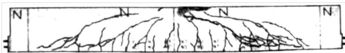
Figura 6-45 Padrão de fissuração de viga VS-A1 de Vecchio e Shim 2004 (fonte: Vecchio e Shim, 2004)
