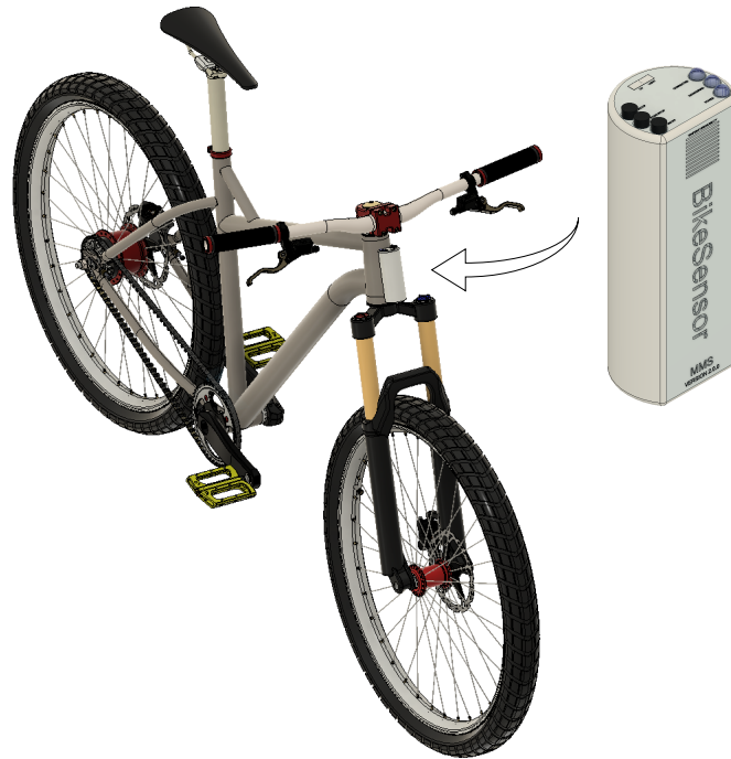
Figura 4.9: Simulação de acoplamento da versão final da MMS em uma bicicleta.
