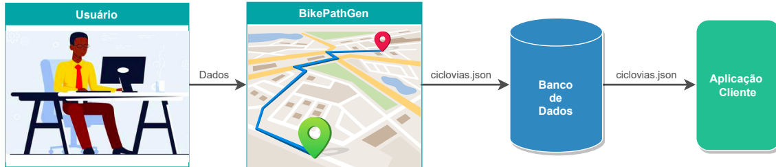
Figura 3.4: Diagrama geral do BikePathGen apresentando o processo de cadastro e armazenamento dos dados das ciclovias.
