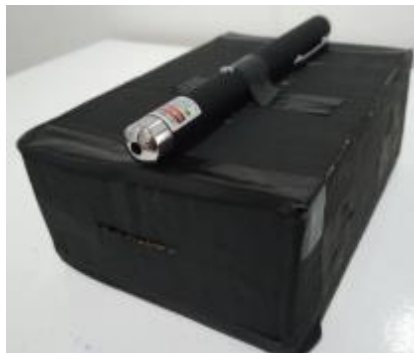
Figura 6.5 – Espectroscópio A com um apontador LASER posicionado na parte superior
