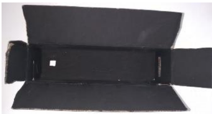
Figura 4.16 – Interior do espectroscópio pintada na cor preta
