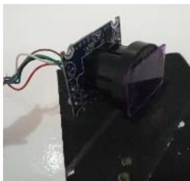
Figura 4.22 – Lente, CMOS e o fragmento de DVD , fixados na base do espectroscópio
