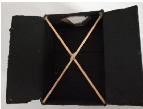
Figura 4.3 – Vista superior do interior do espectroscópio pintado na cor preta
