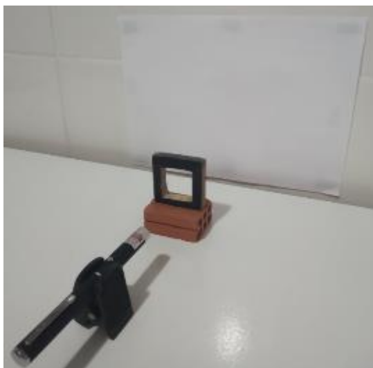
Figura 6.28 – Sistemas para medição da espessura de um fio de cabelo: caneta LASER fixada em uma haste, suporte com os três fios de cabelo e folha de papel fixada na parede (anteparo)
