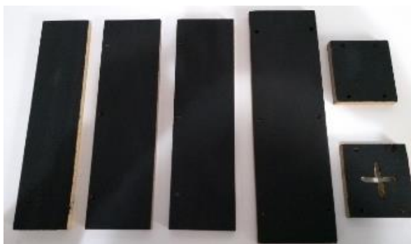
Figura 4.19 – Perfis de madeira utilizados para construção da estrutura do espectroscópio
