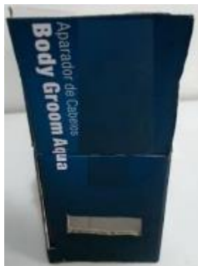
Figura 4.13 – Fenda de entrada da luz para o interior do espectroscópio
