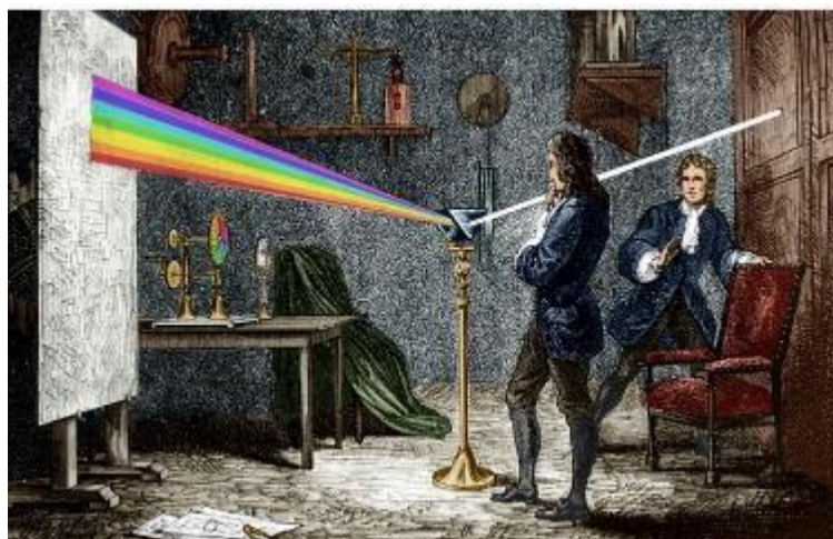
Figura 2.30 – Espectro da luz do Sol observado por Isaac Newton, resultado da refração da luz em um prisma
