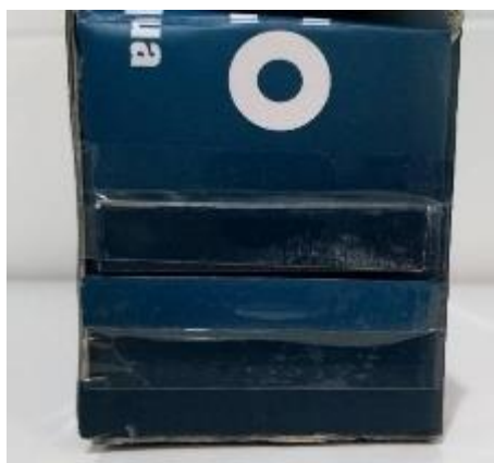
Figura 4.14 – Fenda de entrada de luz da fonte emissora, espessura em torno de 3 mm
