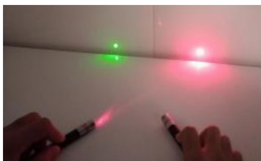
Figura 2.4 - Princípio da independência dos raios de luz: cada feixe de laser se propaga independente do outro
