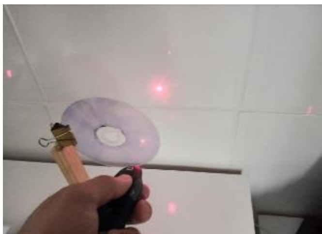
Figura 6.26 – Mídia do DVD posicionado na haste, sendo incidido pelo LASER vermelho
