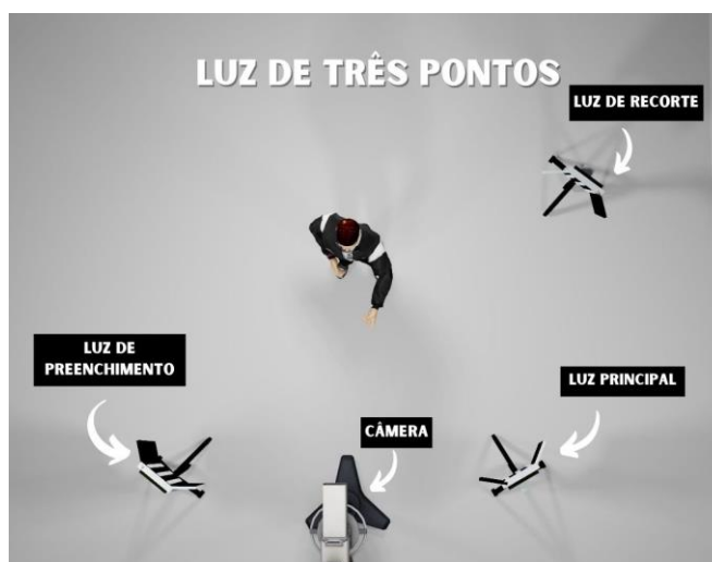
Figura 25: Esquema de iluminação de três pontos (vista aérea)
