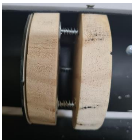
Figura 7: Estrutura do espelho primário - vista lateral
