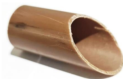
Figura 2: tubo de PVC soldável de 20 mm X 5cm com ponta cortada formando um ângulo de 45°.
