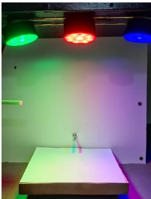
Figura 16: Caixa de cores demonstrando a formação da cor branca no papel sulfite e das cores secundárias representadas pelas “sombras” do parafuso.
