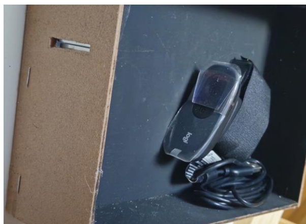
Figura 27: Detalhes do espectrscópio caseiro
