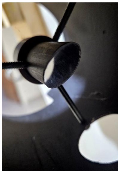
Figura 3: Espelho secundário fixado ao tubo de PVC Soldável de 20 mm.
