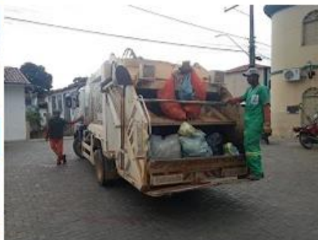
B – Caminhão com sistema de compactação
