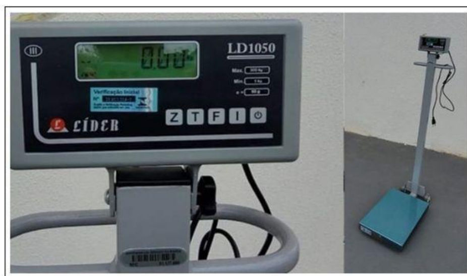
Figura 34 - Imagem da balança utilizada para pesagem dos resíduos, CETIES, Andaraí-Ba, 2023.
