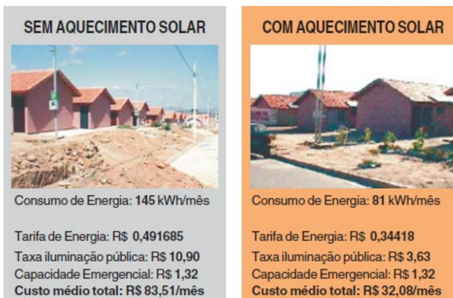
Figura 105 – Comparativo de despesas com o uso de energia solar para aquecimento de água.
