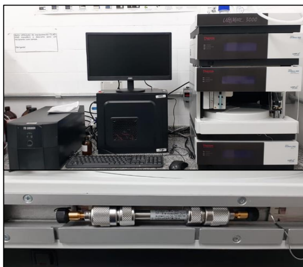
Figura 1.8 - Cromatógrafo (CLAE-DAD) utilizado em análise do perfil químico
