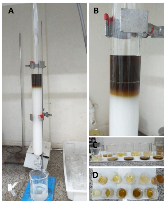
Figura 9: Coluna cromatográfica em sílica flash: (A-B) detalhes para o início da separação; (C-D) frações obtidas e dispostas para concentração.
