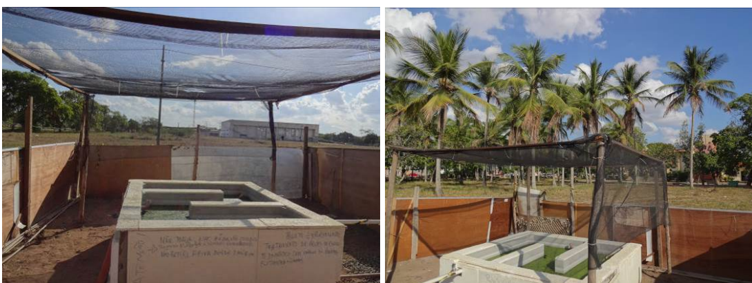
Figura 8 Sistema de tratamento: sombreamento com tela (50% sombra), revestimento do tanque com placas de isopor (50 mm) e o uso de cerca de compensado.
