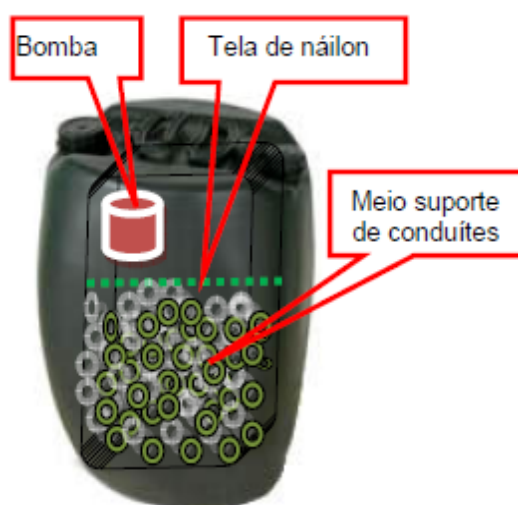
Figura 6 Filtro anaeróbio: bombona com conduítes (20 mm), cortados em tocos de 2 cm e bomba volumétrica (marca Rule - 360 GPH).
