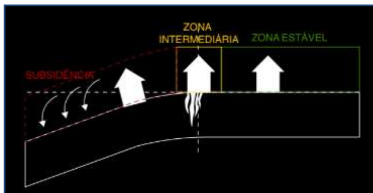
Figura 20: Perfil de zoneamento devido à subsidência em Maceió, Alagoas.
