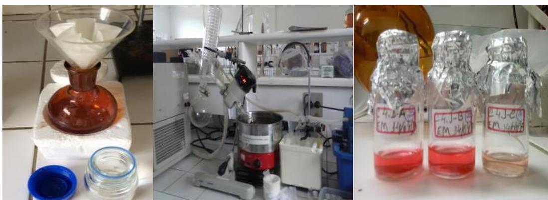
**Figura 7:** Filtração dos extratos e rotaevaporação das amostras.
