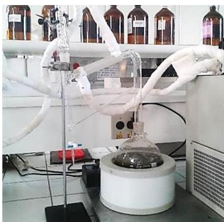
**Figura 4:** Hidrodestilação em aparelho tipo Clevenger.
