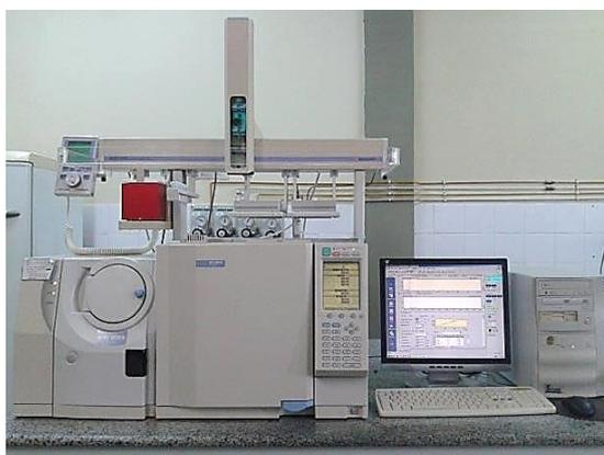
**Figura 5:** Cromatógrafo a gás Shimadzu GC-2010 acoplado a espectrômetro de massas QP-2010 Shimadzu.
