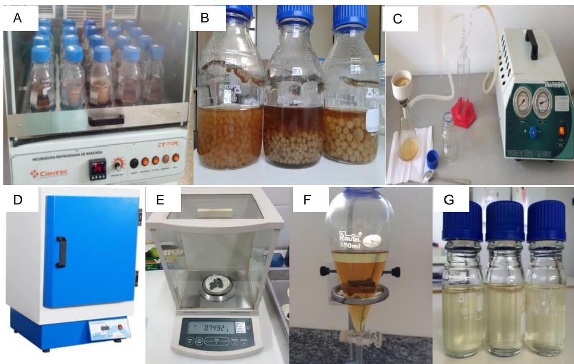
**Figura 6:** Etapas metodológicas utilizadas nas culturas fermentativas em meio líquido (BD e EM): cultivo em *Shaker* sob agitação orbital (120 rpm, 28 °C) (A); amostras obtidas após o cultivo (B); procedimento de filtração (C); seguida de secagem (D) e posterior pesagem da biomassa seca (E); partição líquido-líquido em funil de separação (F); extrato solvente + metabólitos obtidos após o processo (G).
