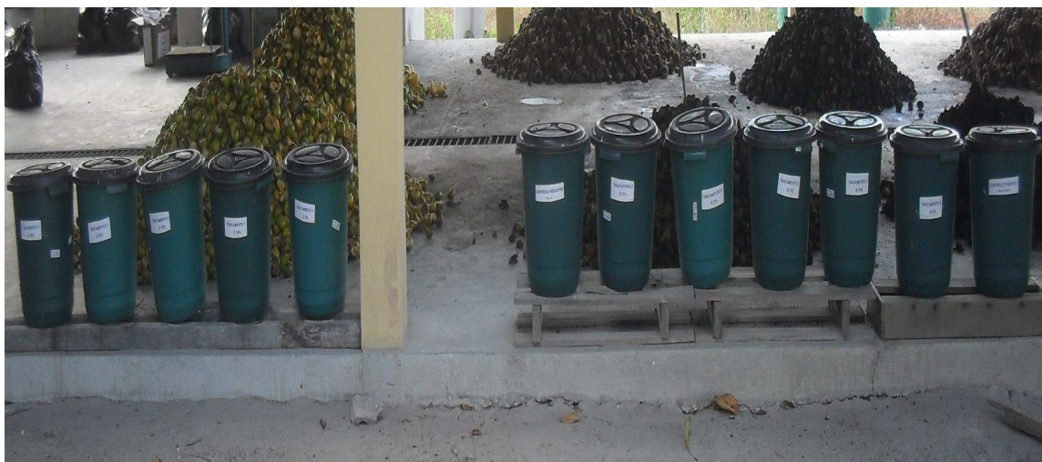
Figura 7: Acondicionamento das amostras em baldes plásticos, de acordo com a concentração de resíduos de manga e cal hidratada.
