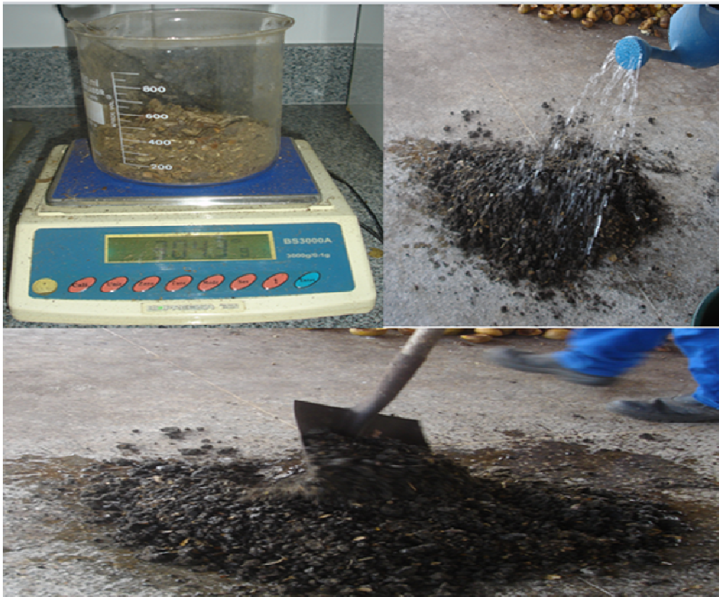
Figura 6: Pesagem, irrigação e mistura dos resíduos.
