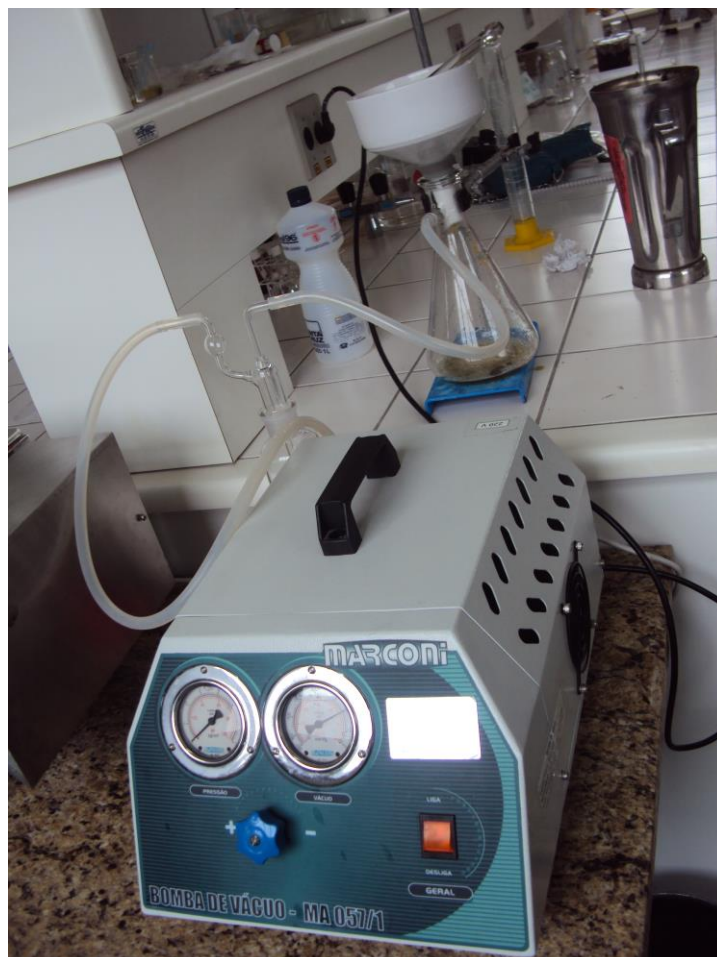
Figura 4. Bomba de Vácuo (MA 057/1 MARCONI), Kitassato e Funil de Büchner para filtração à pressão. Foto da autora.
