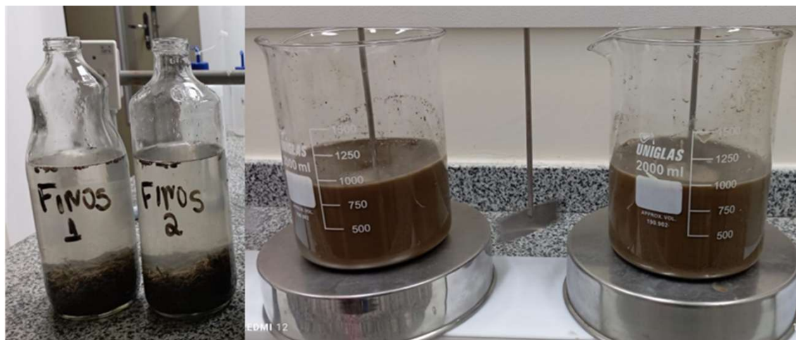
Figura 14 - Produção dos extratos solubilizados (à esquerda) e lixiviado (à direita), do resíduo advindo do Aterro localizado em Santo Antônio de Jesus-BA, para a determinação dos Elementos Potencialmente Tóxicos
