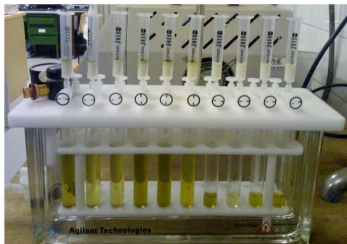
Figura 11: Pré-concentração em cartucho Sep-pak C<sub>18</sub> (Mane Fold).
