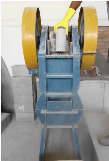
Figura 24: Alimentação do britador de mandíbulas utilizado para produção do AGR
