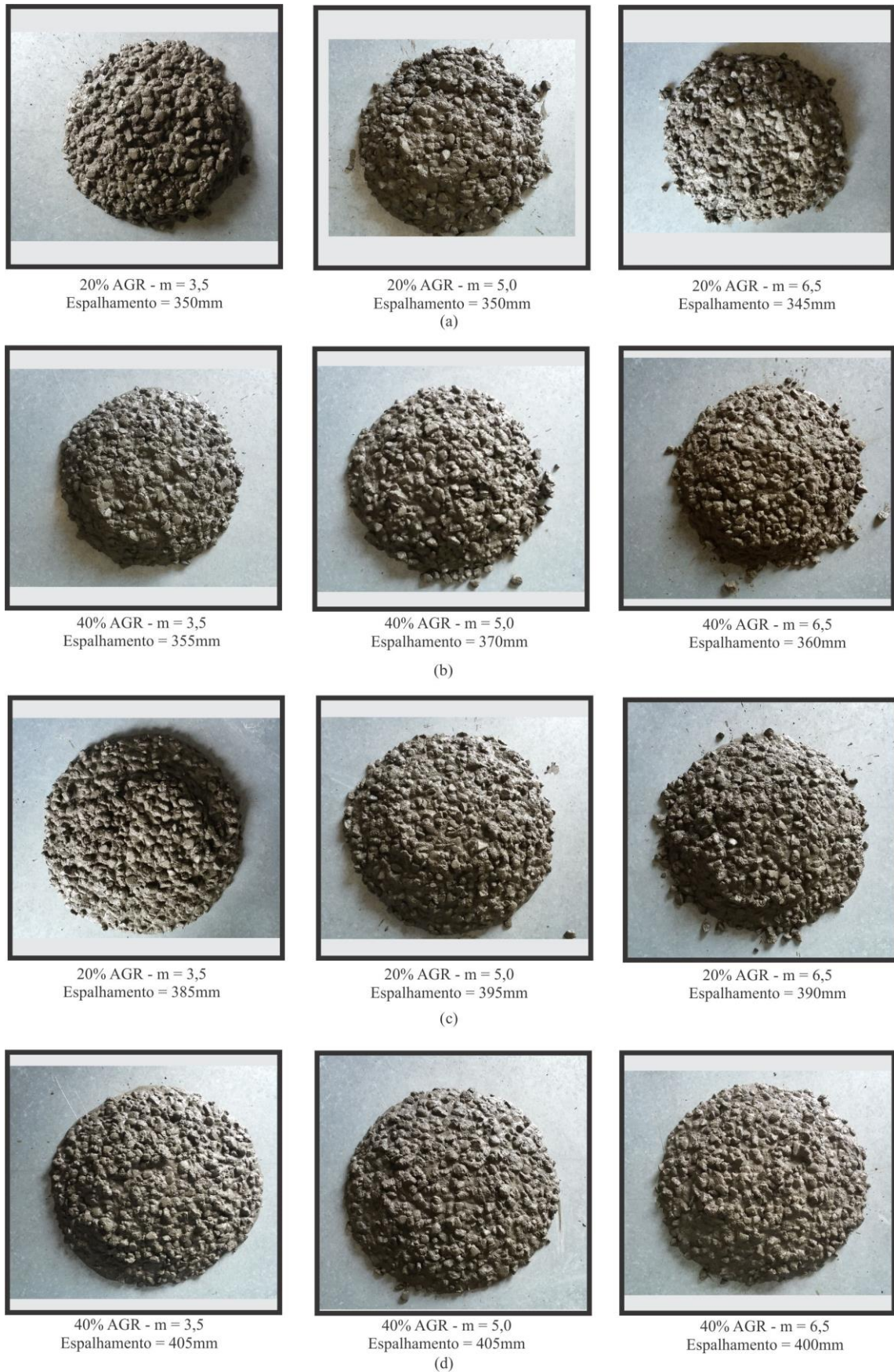
Figura 33: Aspecto dos concretos no ensaio de espalhamento na mesa de Graff, para misturas produzidas pelo método IPT/EPUSP: a) 20%AGR-N1; b) 40%AGR-N1; b) 20%AGR-N2; d) 40%AGR-N2
