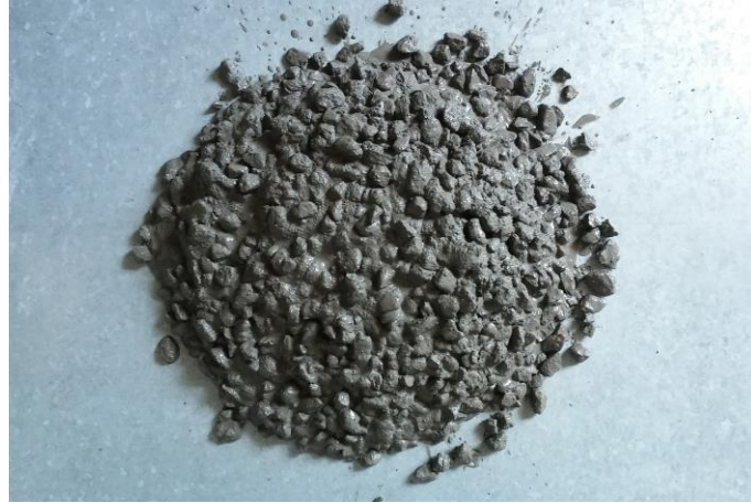
Figura 31: Ensaio de espalhamento da mistura com fcd de 25MPa-20%AGR-N1, com traço inicial na qual observa-se falta de coesão e segregação da mistura
