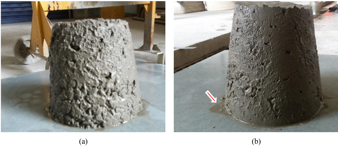
Figura 32: Aspectos das misturas de concreto reciclado durante o estudo experimental - traço fcd 25MPa-20%AGR-N2: a) Teor de argamassa inicial = 50%; b) Teor ideal de argamassa = 52%, apresentando leve exsudação de água
