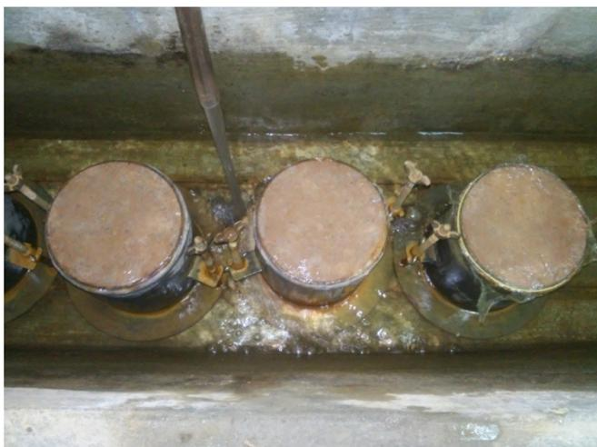
Os corpos de prova permaneceram por 96 dias no tanque de imersão. Considerou-se como saturada a amostra, quando a sua superfície mostrou um brilho característico de presença de água no material, de acordo com a metodologia adotada por Lins (2004).
