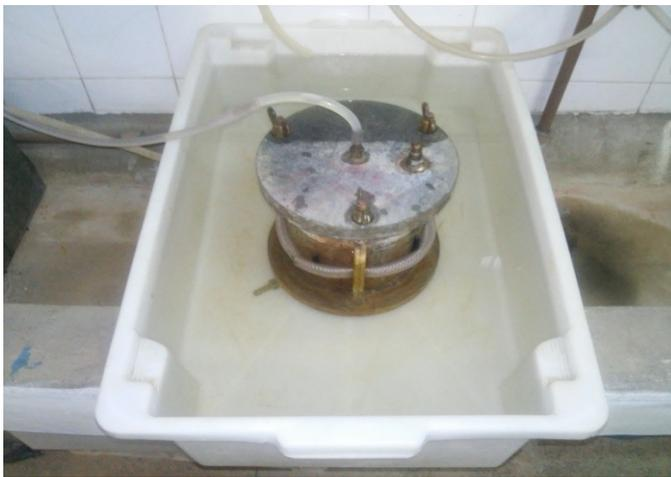
Após a saturação, a tampa do permeâmetro e a camada drenante foram removidas, e o conjunto foi devidamente pesado. O ensaio de evaporação foi realizado no laboratório de solos, deixando-se evaporar pelo topo a água contida no CP. Foram monitoradas diariamente, além de sua massa, a umidade relativa do ar que variou de 54% a 86% e a temperatura do ar, medida entre 26,5°C e 30°C, através de um termo-higrômetro analógico presente na câmara.
