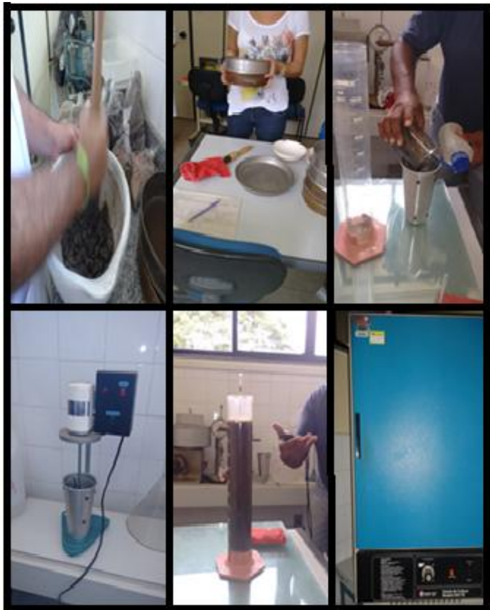
Figura 12. Ensaio de granulometria do sedimento. Laboratório de geotecnia-UEFS.
