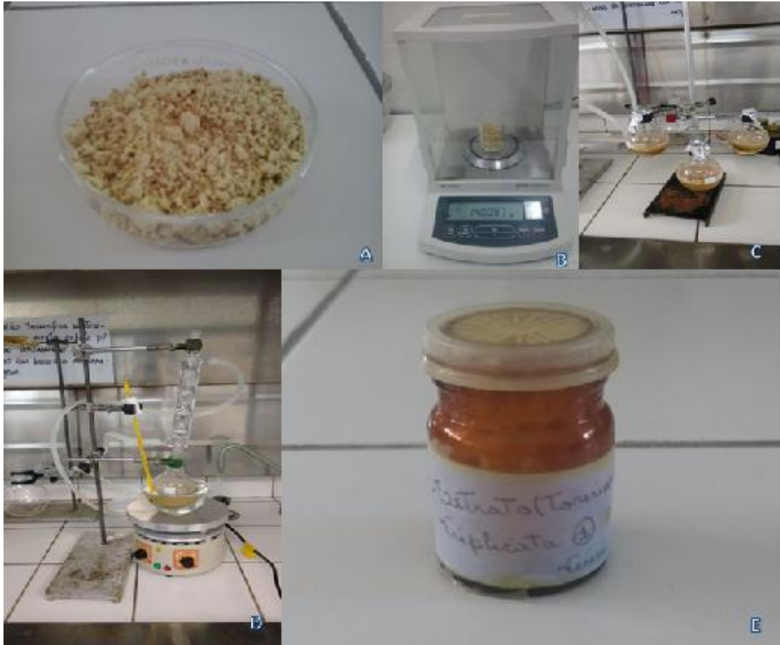
Figura 6: Preparo do extrato bruto etanólico do pólen de Corymbia torelliana . A- Amostra de pólen de C. torelliana homogenizada; B- Pesagem do pólen para produção da solução; C- Preparo da solução etanólica do pólen; D- Amostra em banho Maria em óleo de silicone a 70°C; E- EEP de C. torelliana .
