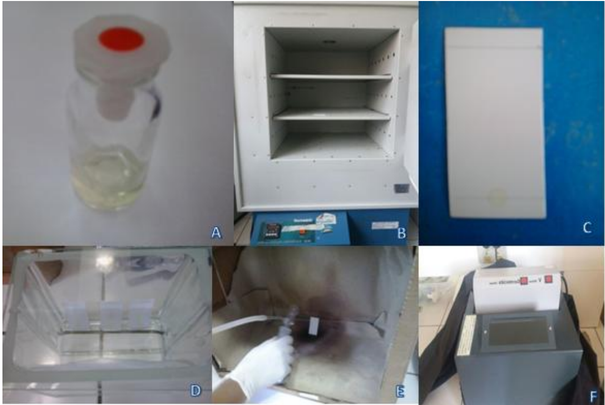
Figura 8: Metodologia adotada no teste da Cromatografia em Camada delgada (CCD). A- solução feita com o extrato etanólico bruto da espécie C. torelliana , B- Ativação da placa de alumínio a ser utilizada no teste, C- Placa de alumínio com gota da solução do extrato C. torelliana , D- cubas cromatografica de vidro contendo sistem de eluição (diclorometano1/1 acetona + uma gota de ácido acético), E- Caixa onde as placas são pulverizadas com reveladores, F- aparelho para observação das placas em luz UV-365 nm e luz germicida 254 nm.
