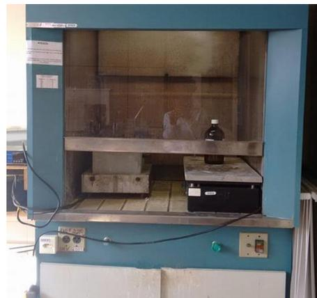
**Figura 4. a.** Inserção da mistura de ácidos nas amostras. **b.** Amostras no bloco digestor dentro da capela. Feira de Santana, 2016.
