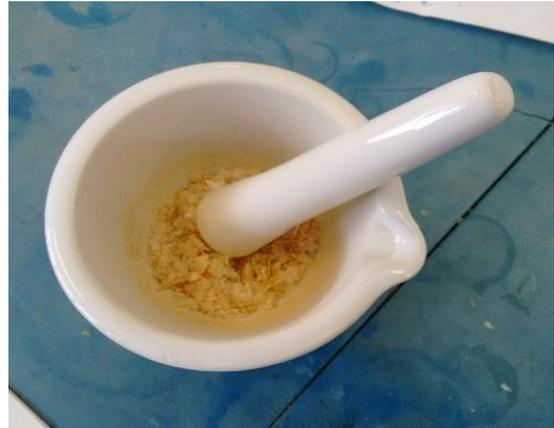
**Figura 3:** Equipamentos utilizados na preparação das amostras. **a.** Moinho Analítico IKA A11 basic. **b.** Pistilo e almofariz com amostras de exoesqueletos. Feira de Santana, 2016.
