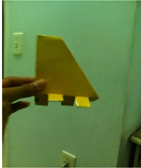
Figura 17: Construindo as aletas do foguete
