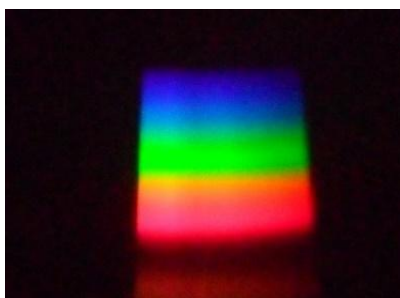
Figura 42 - Espectro do Sol imageado por estudantes a partir de um espectroscópio didático.
