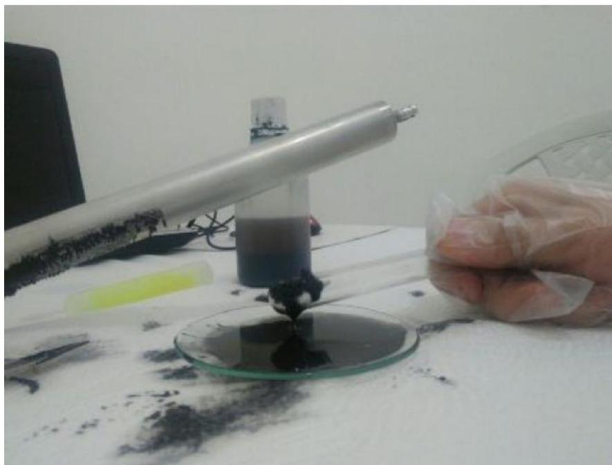
**Figura 20:** Aproximação de campo magnético (ímã) junto ao ferrofluido.
