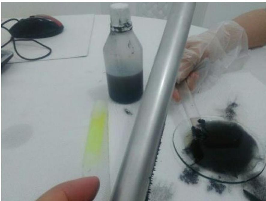
**Figura 21:** Nanopartículas atraídas pelo campo magnético do ímã cilíndrico.
