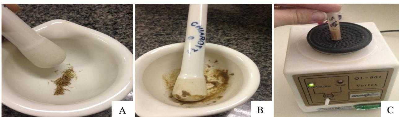
**Figura 3:** Processo de obtenção dos extratos florais de *Physalis angulata* L. (A) Estigmas retirados dos botões/flores e dispostos em cadinhos para posterior maceração; (B) Ovários sendo macerados; (C) Amostra sendo agitada em vórtex. UEFS/Horto Florestal, Feira de Santana-BA, 2016.
