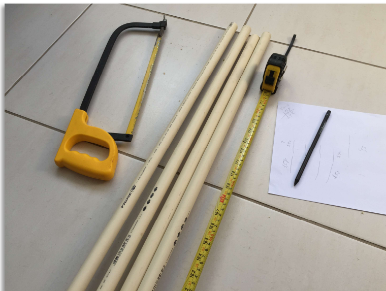
Figura 39 – Tubos de PVC e ferramentas na montagem do suporte da antena dipolo
