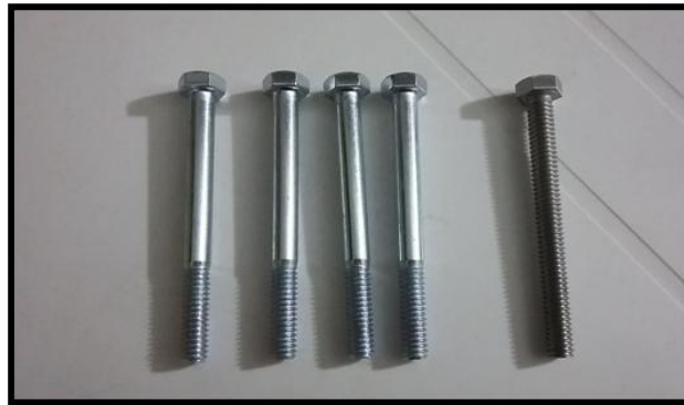
Figura 5.19 – Os quatro parafusos à esquerda são suportes para a base. O quinto parafuso tem o papel de elevador para o mostrador no Relógio de Sol – Fonte: Autor.
