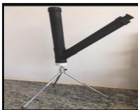
Figura 8 – Espectroscópio feito com tubo de PVC e tripé. Fonte: Autor.
