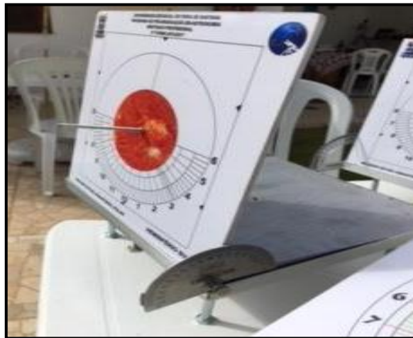
Figura 5.24 – Fotografia do Relógio de Sol, com goniômetro em 180^\circ e gnômon em metal. Fonte: Autor.
