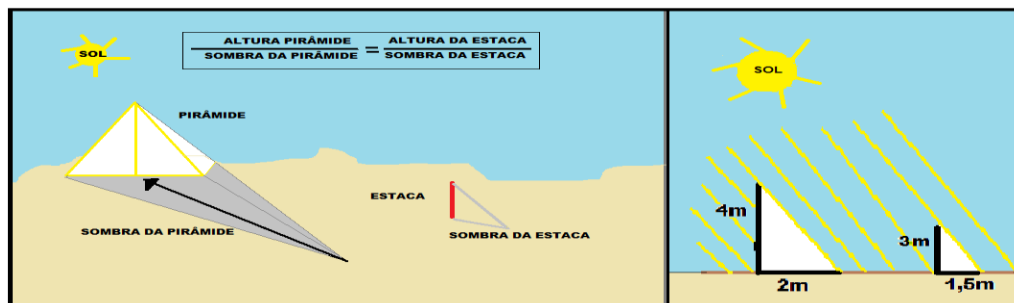
Figura 2.9 – Representação do experimento que Tales realizou para a medição da altura de uma pirâmide. Através da proporcionalidade, ele utilizou a semelhança entre triângulos para identificar a altura da pirâmide, comparando a medida da sua sombra, relacionada com a medida da sombra da vara e o seu comprimento. Fonte: Autor.
