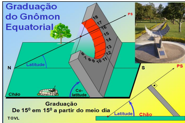
Figura 3.13– Representação do projeto de montagem de um Relógio de Sol Equatorial e foto do produto final. Fonte: BOCZKO (Relógios de Sol – III SeITA/Bauru-SP, 2017).
