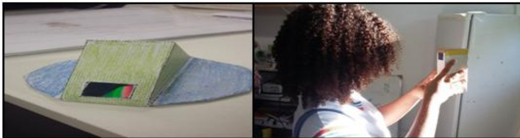
Figura 5 – Fotografia do modelo proposto de espectroscópio montado, exibindo espectros luminosos, e a direita, uma estudante utilizando um modelo adaptado por ela. Fonte: autor.
