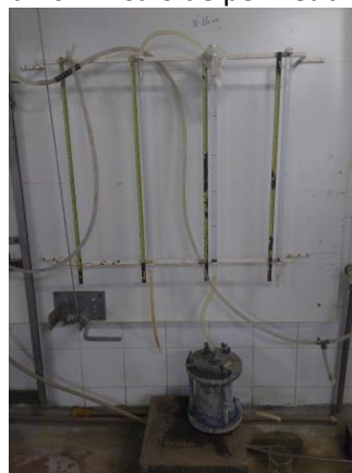
Figura 10 - Ensaio de permeabilidade
