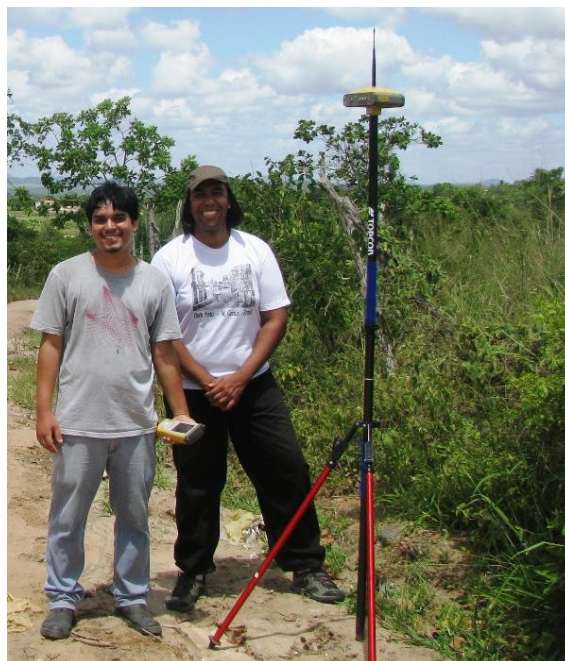
Figura 8: GPS Geodésico de dupla frequência, utilizado para traçar o perfil vertical das vertentes. À esquerda a base fixa do aparelho, instalada no marco geodésico de referência da UEFS, à direita o equipamento móvel, levado para campo para a coleta dos dados.
