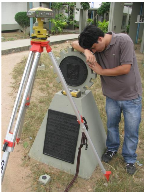
Figura 8: GPS Geodésico de dupla frequência, utilizado para traçar o perfil vertical das vertentes. À esquerda a base fixa do aparelho, instalada no marco geodésico de referência da UEFS, à direita o equipamento móvel, levado para campo para a coleta dos dados.
