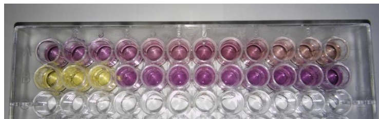
Figura 29 - Teste DPPH: aspecto das amostras e do padrão após execução do ensaio
