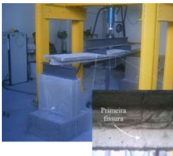
Figura 4.18 Configuração do ensaio de flexão das vigas e indicação da fissuração Fonte: Aragão (2007)
