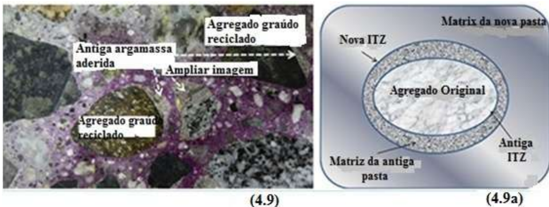
Figuras 4.9 e 4.9a Interface do agregado reciclado. Fonte: Taboada et al (2016)
