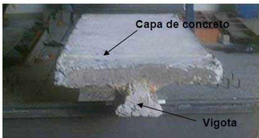
Figura 4.17 Seção T após a moldagem e antes do ensaio. Fonte: Aragão (2007)
