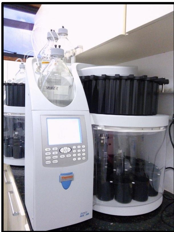
Figura 9: Equipamento de Extração Acelerada por Solventes (ASE) Thermo Scientific Dionex ® ASE 350.
