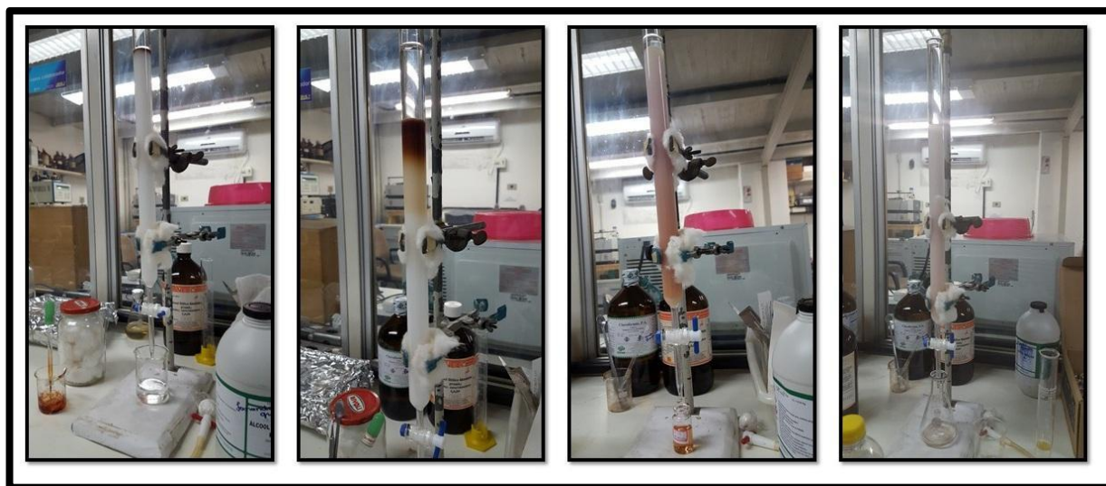
Figura 13: Processo de fracionamento em cromatografia em coluna (Sephadex-LH20®) com a fração Hm-Fr.AcOEt do extrato das cascas de Hymenaea martiana .
