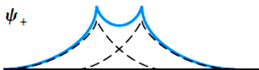
Figura 3. Função de onda resultante da combinação simétrica dos orbitais atômicos centrados em r=0 e r=R . (SERWAY et al, 2005. p.393)
