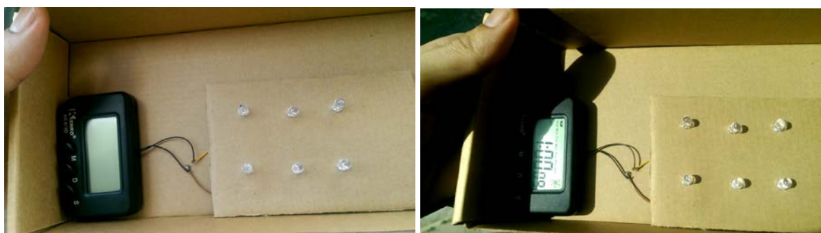
Circuito (simples painel solar) para acionar um relógio digital.
