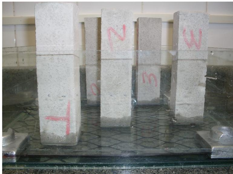
Figura 17 Ensaio de absorção de água nas argamassas
