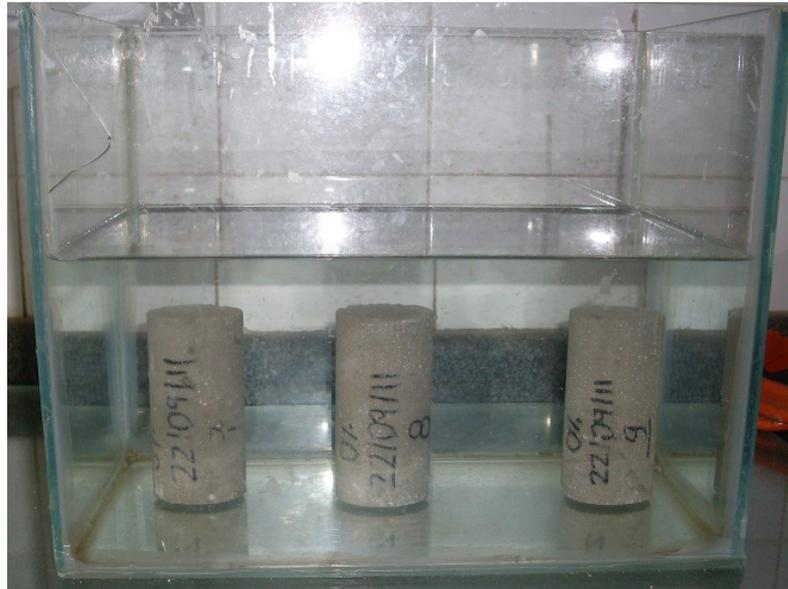
Figura 16 Corpos-de-prova imersos em água para execução do ensaio de absorção
