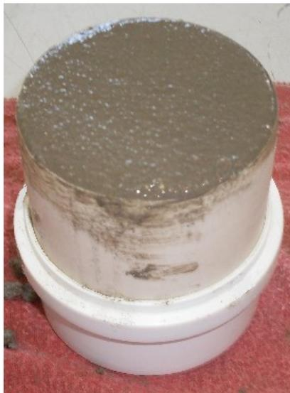
Figura 10 Recipiente cilíndrico de PVC para determinação da massa específica
