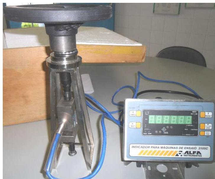
Figura 14 Equipamento para determinação da resistência de aderência à tração
