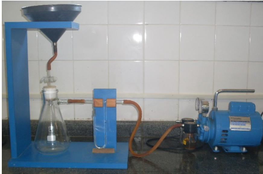
Figura 9 Aparelho para determinação de retenção de água
