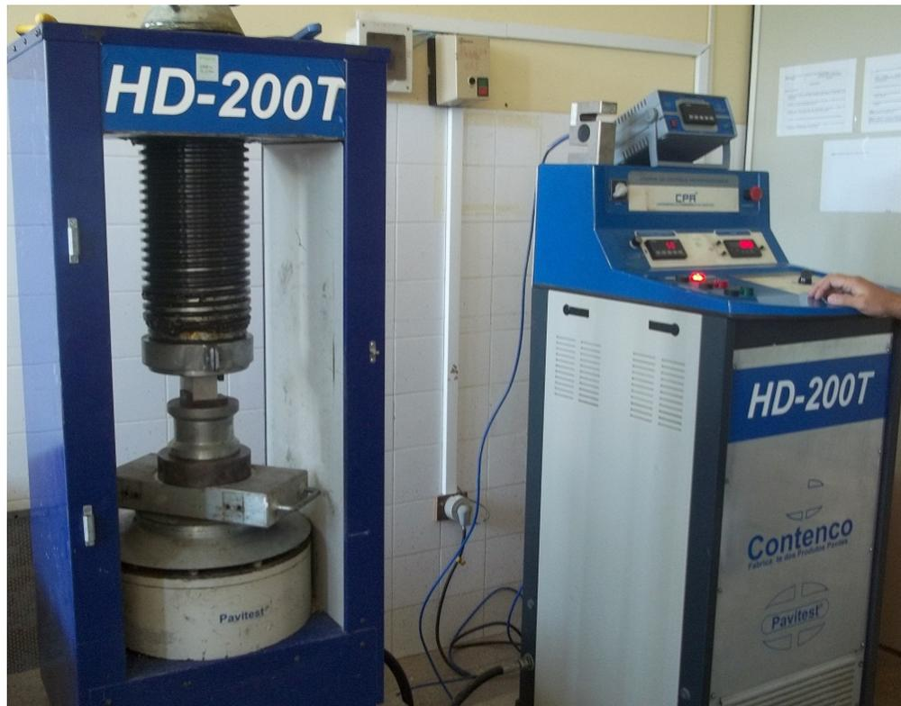
Figura 11 Prensa hidráulica para os ensaios mecânicos
