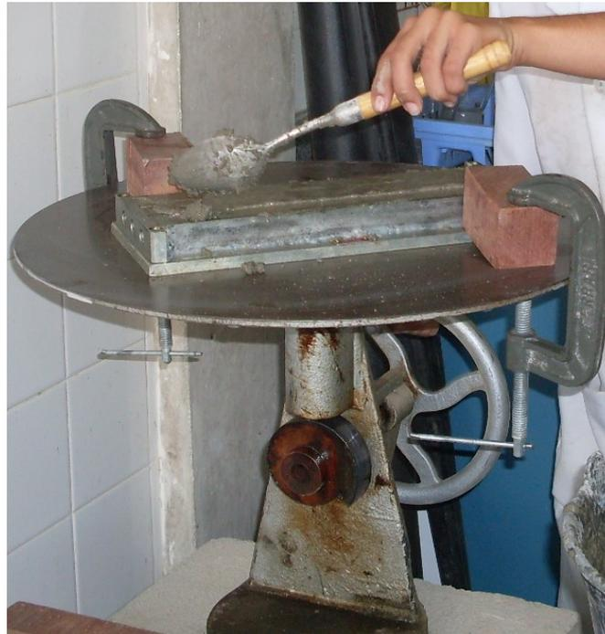
Figura 15 Adensamento dos CPs para determinação da retração
