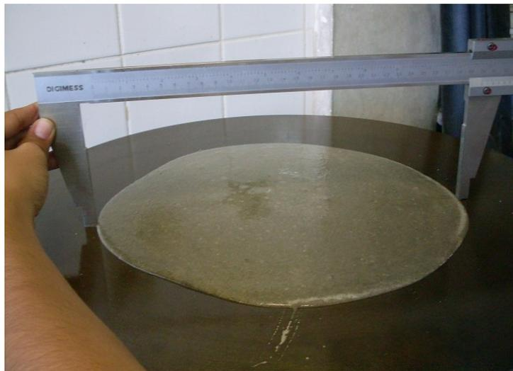
Figura 8 Aspecto da determinação da consistência (mesa de consistência)
